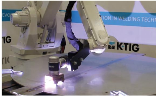
단일한 가공 비드의 키홀 용접 304스스 6mm에 500mm/min속도로 작업
