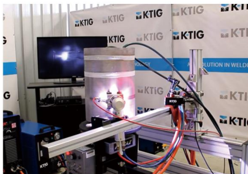
2G 용접 (2G welding) 304서스 4.2mm에 용접 실행
